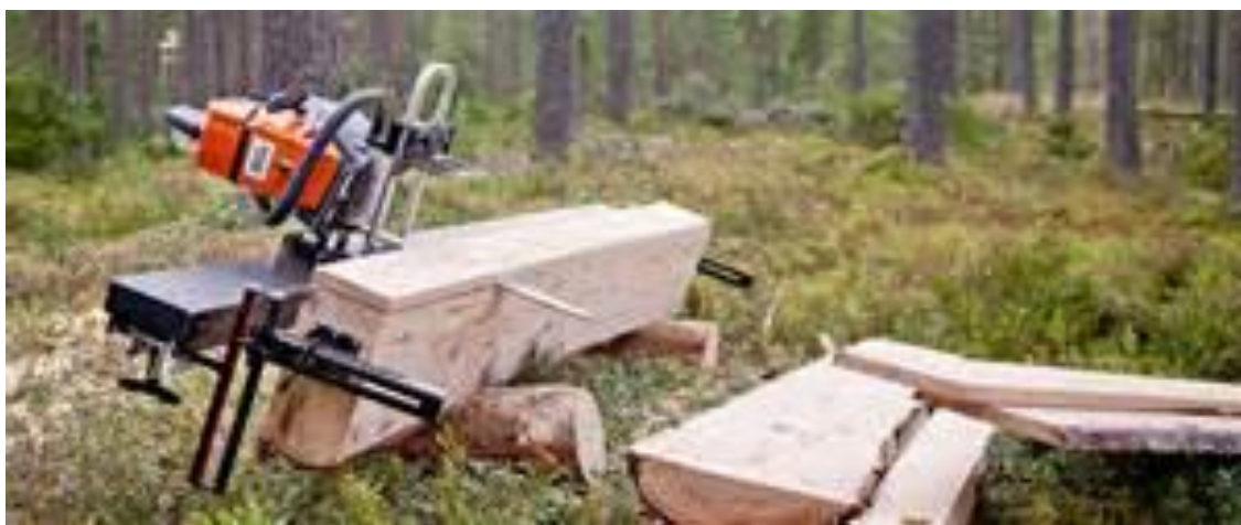
Fig. 13. Scierie mobile : Utilisation d'une tronçonneuse avec une barre pour guider la scie.
